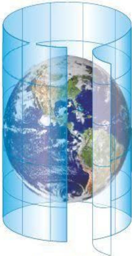
Projeção cilíndrica O plano da projeção é um cilindro envolvendo a esfera terrestre.
